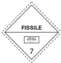
放射性物品 UN Transport symbol for radioactive substances
